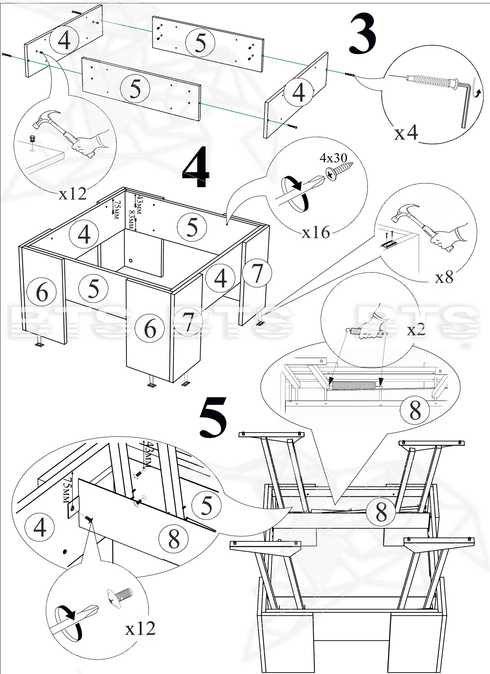
**Шурупы 4x16 вкручивать не прилагая чрезмерного усилия!**
